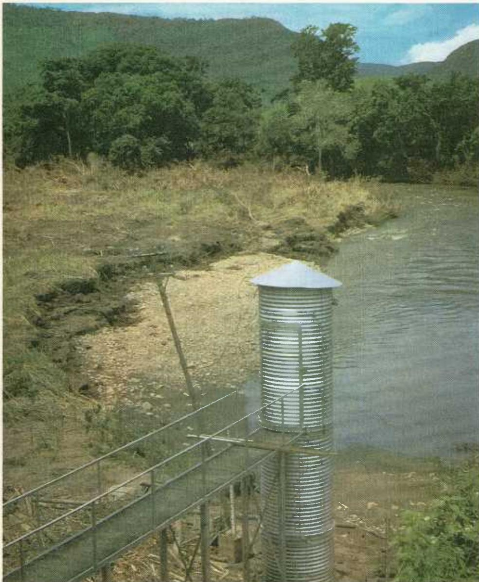
• *Aparato instalado en el borde del cauce del río Neverí, para medición continua de los niveles de agua y transmisión automática de la información, la cual es procesada e interpretada a la luz del comportamiento histórico del río. Se puede así pronosticar la ocurrencia de crecientes en un plazo mínimo de 50 horas, con fines de asegurar la prevención y protección de personas y bienes en la ciudad de Barcelona.*
